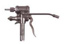
Valvola erogatrice per oli-grassi leggeri-pesanti. Eroga fino a 28 gr. al ciclo ( premendo e rilasciando la leva ). Una vite di regolazione permette la dosatura del lubrificante da erogare: Provvista di attacco idraulico 6304-B Attacco 1/4" NPTF ( f )
