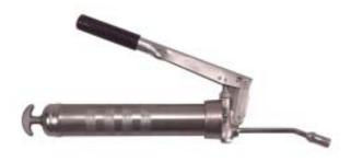
Pompa a leva servizio pesante Presione 700 Bar Portata 30 gr. per 36 colpi Equipaggiata con con estensione 6638
